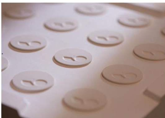
Esferas moldeadas antes del primer horneado.
